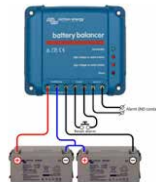
Battery Balancer (BMS012201000) El Battery Balancer (equilibrador de baterías) equilibra el estado de la carga de dos baterías de 12 V conectadas en serie, o de varias cadenas paralelas de baterías conectadas en serie. En el caso de que la tensión de carga de un sistema de baterías de 24 V aumente por encima de los 27 V, el Battery Balancer se activará y comparará la tensión que llega a las dos baterías conectadas en serie. El Battery Balancer retirará una corriente de hasta 1 A de la batería (o baterías conectadas en paralelo) que tenga la tensión más alta. El diferencial resultante de corriente de carga garantizará que todas las baterías converjan en el mismo estado de carga.
