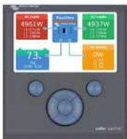
Color Control GX mostrando Una aplicación FV
