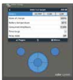
Color Control El potente ordenador Linux que se esconde tras la pantalla de color y los botones recoge los datos de cualquier equipo Victron y los muestra en pantalla. Además de comunicarse con equipos de Victron, el Color Control se comunica a través de CAN bus (NMEA 2000), Ethernet y USB. Los datos pueden almacenarse y analizarse en el Portal VRM.
